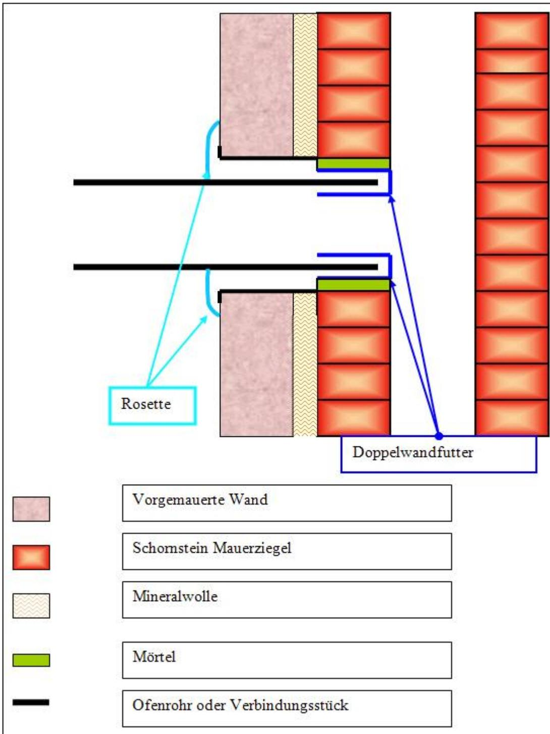
Anschluss eines Verbindungsstückes an einen mehrschaligen Schornstein
