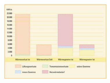
Im Säulendiagramm können Sie die Energiegewinne und die Energieverluste bei Ist-Zustand und Soll-Zustand nach Umsetzung aller vorgeschlagenen Maßnahmen ablesen.
